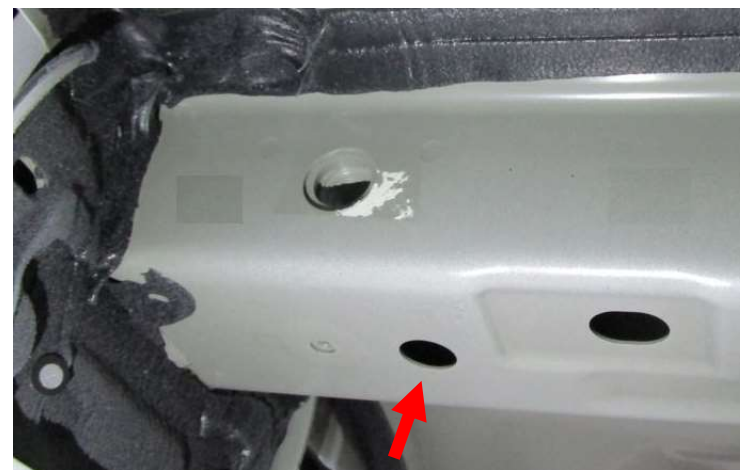
Ampliar el orificio de acceso por ambos lados
