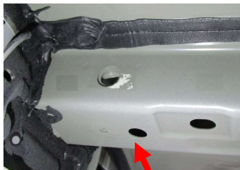
Ampliar el orificio de acceso por ambos lados
